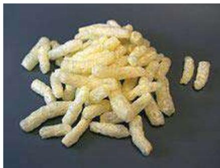
«Упаковочный арахис», изготовленный из термопластичного крахмала.
