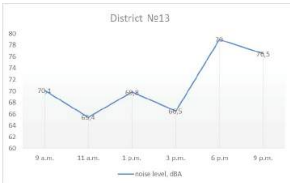
Рисунок 7 - Изменение уровня шума в течении дня на пересечении улиц Оренбургский тракт – Проспект Победы
