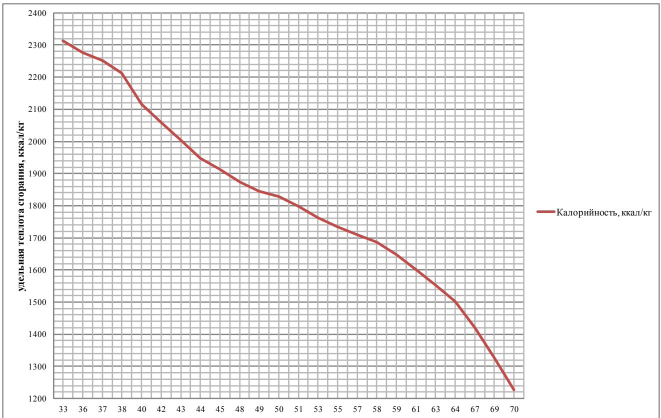
Рис. 3 «График зависимости удельной теплоты сгорания щепы осиновой от влажности»
